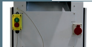
"Start" and "Stop" remote control, and power supply Pulsantiera "start and stop" per controllo a distanza, e presa di potenza
