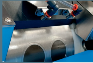
Extraction system through compressed air Sistema di estrazione ad aria compressa
