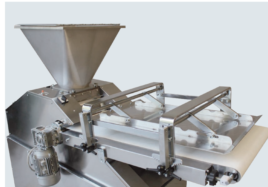
Independent engine of the belt Motorizzazione indipendente del tappeto.
